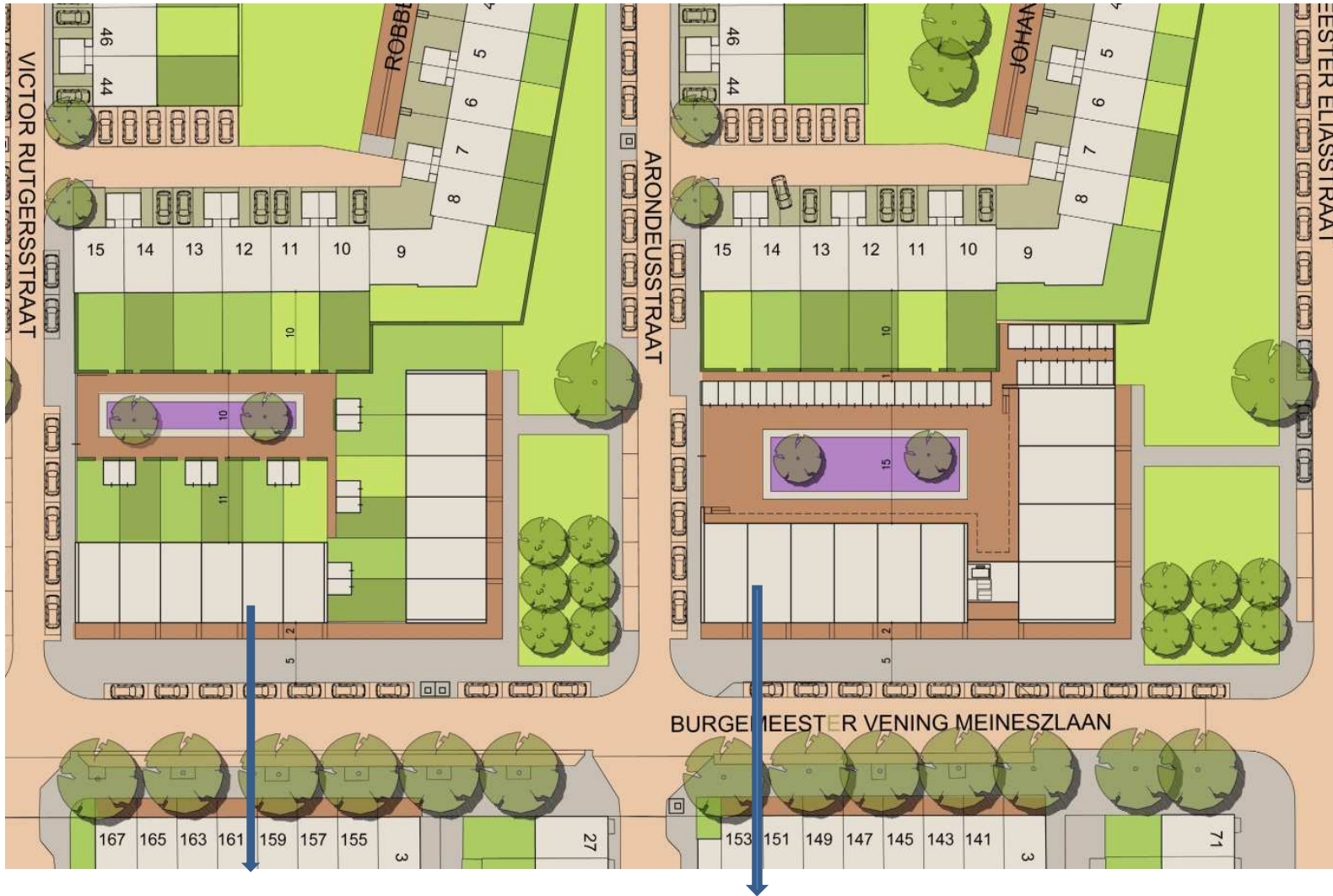
12 eengezinswoningen, bouwhoogte 9,5 meter
